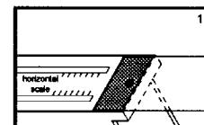
Klebefolie mitsamt der horizontalen Skala an einer Ecke vorsichtig anheben und flach in Pfeilrichtung abziehen. (Skizze 2)
